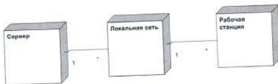
Рис. 19. Фрагмент диаграммы развертывания с соединениями между узлами
