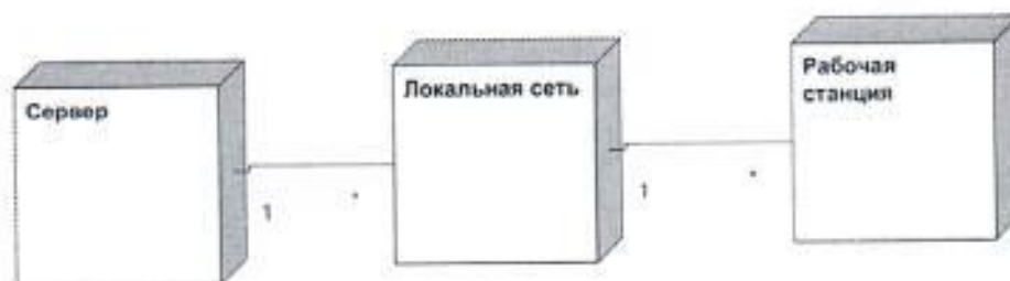
Рис. 19. Фрагмент диаграммы развертывания с соединениями между узлами
